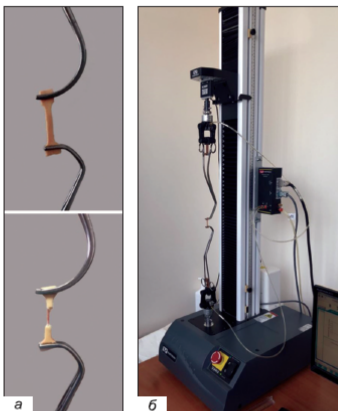
Рисунок 4 – Процесс механометрического испытания образца стенки аорты: а – образец ткани восходящей аорты, закреплённый в атравматичных зажимах; б — испытательная машина Instron 3343 с закреплённым образцом ткани аорты
